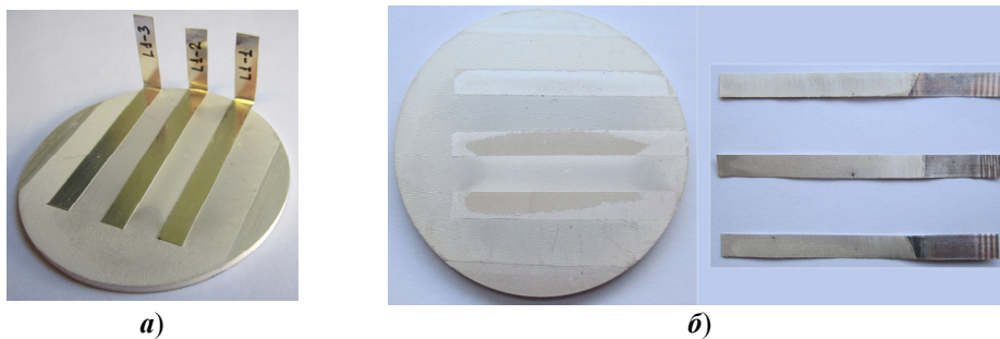
Рис. 2. Внешний вид образцов МТ для испытаний адгезионных свойств спеченного слоя СП методом L -отслаивания: а — до испытаний, б — после испытаний
